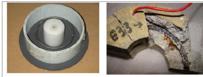
Figure 10: Dispositif de l'essai de fissuration par cœur expansif (Cremona et al. 2011)
