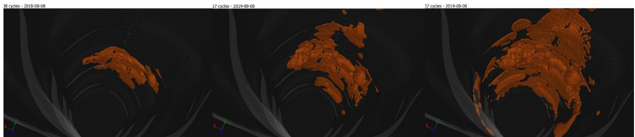
Figure 3: Evolution temporelle du volume d'acier dissout par corrosion en surface d'un acier HA6 (vue depuis l'intérieur de l'acier) au niveau d'une fissure régulièrement alimentée en chlorures - Images obtenues par traitement de scan \mu\text{CT-X} effectués à différentes échéances sur un échantillon en mortier de section 4cm x 4cm – Taille des Voxels \sim 20 \mu\text{m} – Images Takwa Sayari - CEA
