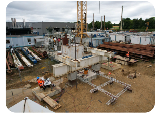
Essais de chargement sur le site de NGE ©PN ASIRI+
