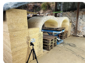
ANR Menhir : essai sur une double-voûte expérimentale soumise à un tassement d'appui ©J. Archez (ENPC)
