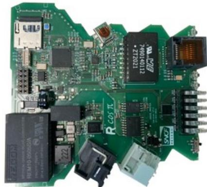
Ce système mesure et transmet les signaux de passage de train générés par le compteur d'essieux.
