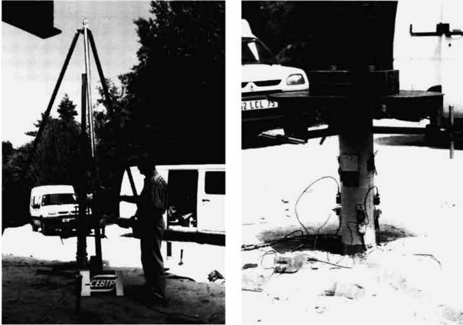
Figure 2.28. Tripode de chargement dynamique et instrumentation du micropieu.
