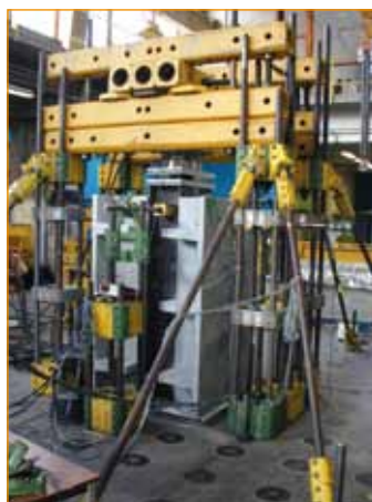
Essai Push-out de la connexion dalle gauffrée BFUP - charpente métallique. © LCPC
