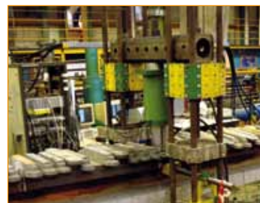
Essai à rupture d'une poutre mixte préfalcée de nouvelle génération. ©LCPC
