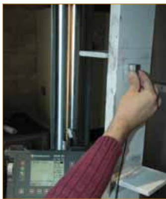
Contrôle non destructif par ultrasons.
