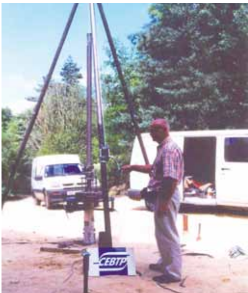
Essai de chargement dynamique d'un micropieux à Saint-Rémy- lès-Chevreuse - CEBTP
