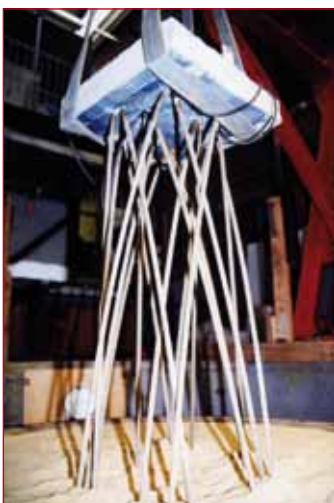
Grenoble Modèle réduit d'un réseau de 18 micropieux testés dans la grande cuve du labo 3S de Grenoble.
