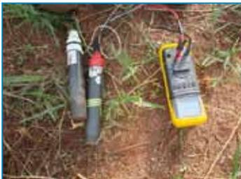
Détection d'une circulation d'eau dans un environnement poreux par la mesure de la distribution du potentiel électrique à la surface du sol. ©EDF
