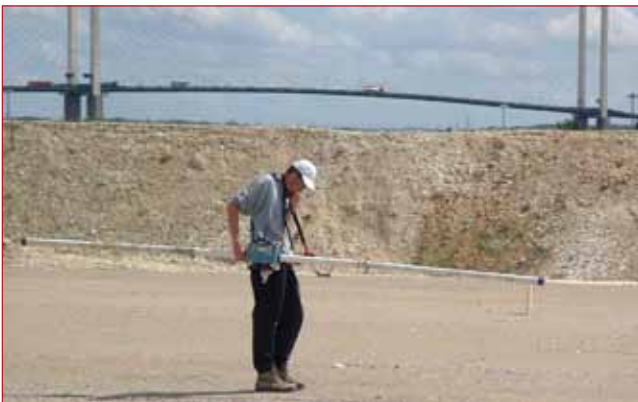
Méthode Slingram : prospection géophysique à l'EM 31. © Pierre Frappin - EDG
