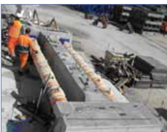
Corps d'épreuve : Bloc prismatique en retrait gêné.
