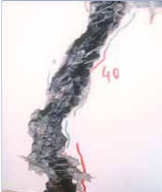
Rupture brutale du voussoir d'essai.
