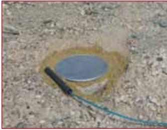
Chantier expérimental de Saint-Ouen l'Aumône. Pose d'un capteur de pression totale.
